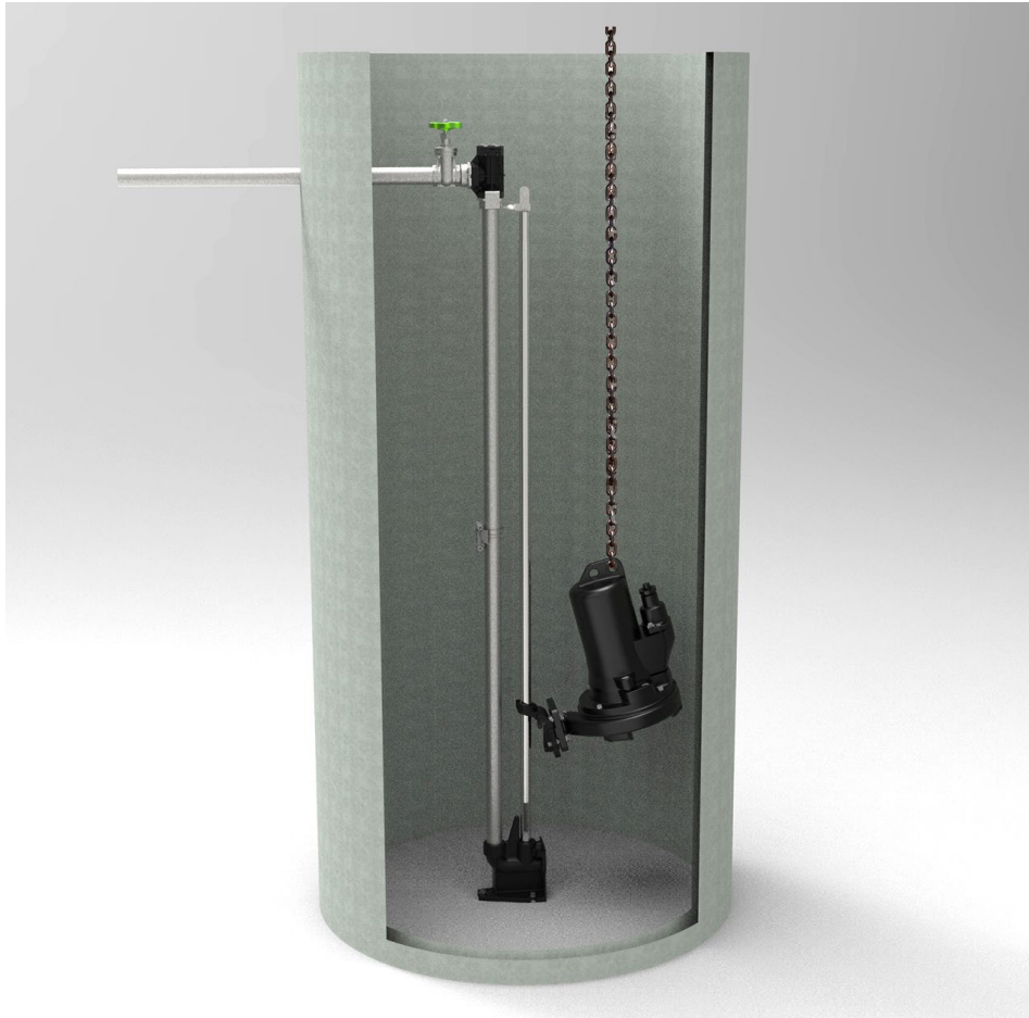
Bild 2: Einbauset im Betonschacht installiert. An der Kupplungsklaue gleitet die Pumpe an einer Kette am Gleitrohr schlüssig in die Fußkupplung am Schachtboden.
