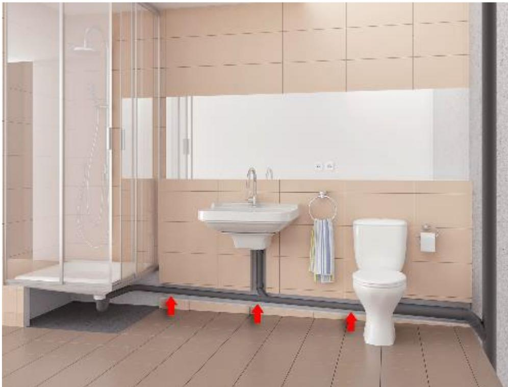
Abb. 2a: **Vorher:** Das Duschwasser fließt in freiem Gefälle aus der hohen Duschwanne in das Abwasserrohr in der Wand. (Bild: Jung Pumpen GmbH)
