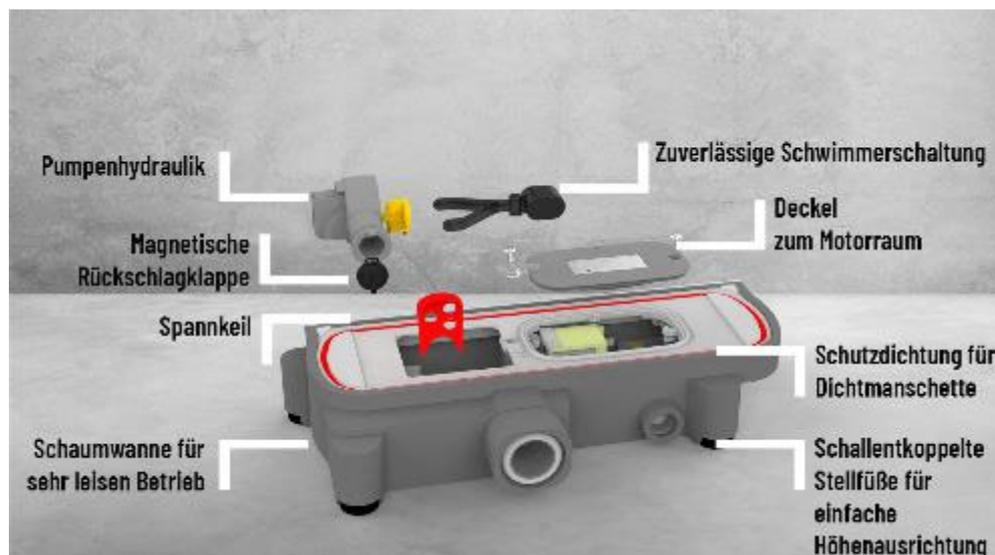
Abb. 3: **Der Plancofix Connect:** Eine kleine Pumpe im Bodenablauf fördert das verbrauchte Duschwasser leise und zuverlässig in das vorhandene Abwassersystem und ermöglicht so eine barrierefreie Dusche im Bestand. (Bild: Jung Pumpen GmbH)
