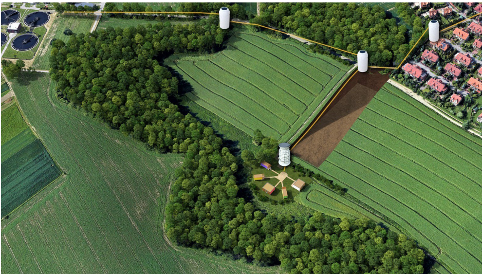
Bild 2: Tiny House Siedlung (unten), die über ein Druckentwässerungssystem mit der öffentlichen Kanalisation verbunden wird und damit das Abwasser ordnungsgemäß aufbereiten lässt. (Jung Pumpen)
