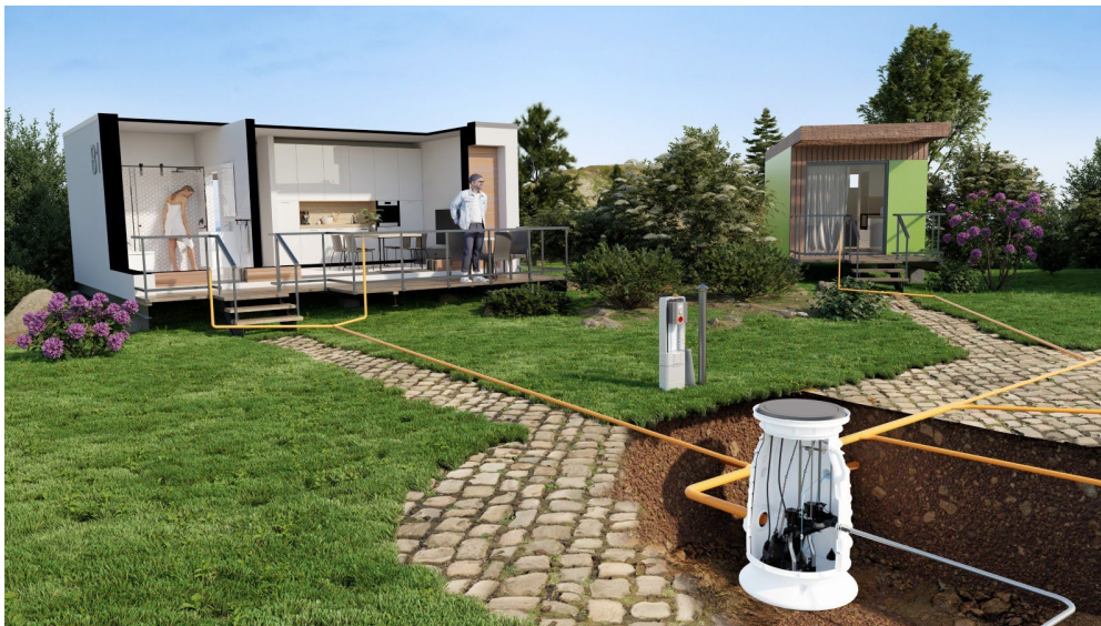
Bild 4: Querschnitt durch die Abwasserentsorgung im Siedlungsbereich. Tiny Houses führen das Abwasser im Gefälle in den PKS-B Druckentwässerungsschacht, der es dann weiterleitet Richtung Kläranlage (Bild: Jung Pumpen)
