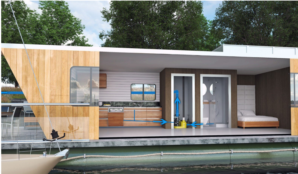
Bild 5: Abwasserentsorgung eines Hausbootes mit einer Compli Hebeanlage (Jung Pumpen)
