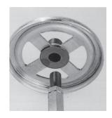
Wellenführungslager gefertigt aus selbstschmierender Buchse in Molybdändisulfid Polyamid und Edelstahlwelle mit Keramikeinsatz an der Verschleißstelle.
