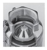
Anschlussadapter in Edelstahl-Feinguss AISI 304 mit Innenkonus-Doppelprofil mit einem Rückschlagventil aus Edelstahl und einem Kabelkanal für das Sicherheitskahel
