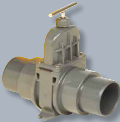
PVC Zulaufschieber DN 100 oder DN 150 mit eingeklebten Rohrstützen für zeit- und platzsparenden Direktanschluss an den Zulaufklemmflansch.
