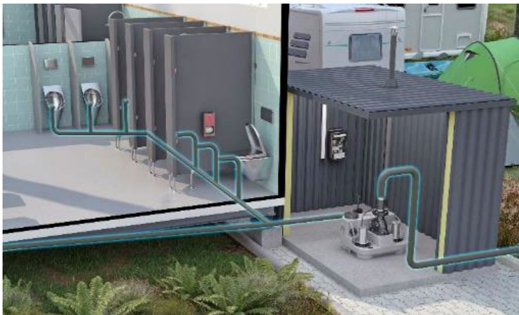
Rys. 2: Przepompownia Compli 1100 E Drena-Line jest kompaktowa a zarazem wszechstronna. W przykładzie powyżej pompuje ścieki z urządzeń sanitarnych kempingu do kanalizacji publicznej, zabezpieczając ryzyko cofania się ścieku
