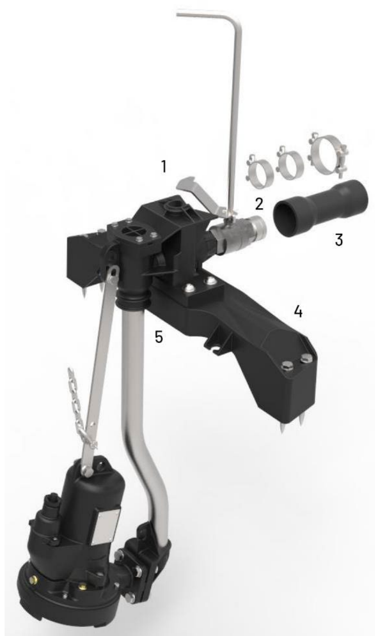
Rys 2: Zestaw wymienny wyposażenia zbiornika z tworzywa sztucznego PKS: 1 system sprzęgający z tworzywa sztucznego wzmocnionego włóknem szklanym, 2 zawór kulowy z blokadą bezpieczeństwa, 3 elastyczne połączenie do indywidualnej regulacji w zbiorniku, 4 trawersa z tworzywa sztucznego wzmocnionego włóknem szklanym, 5 kulowy zawór zwrotny z zespołem rur ciśnieniowych
