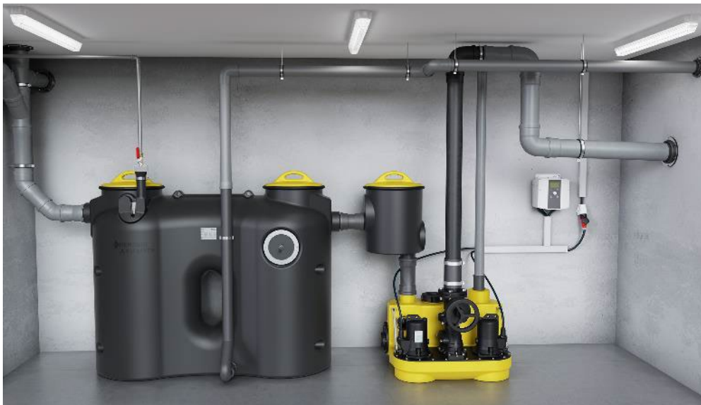
Bild 2: Der kompakte Fettabscheider Splitfix hier mit Probeentnahmebehälter (Zubehör) und nachgeschalteter Compli 1000 Hebeanlage für den Rückstauschutz gemäß DIN 4040-100.
