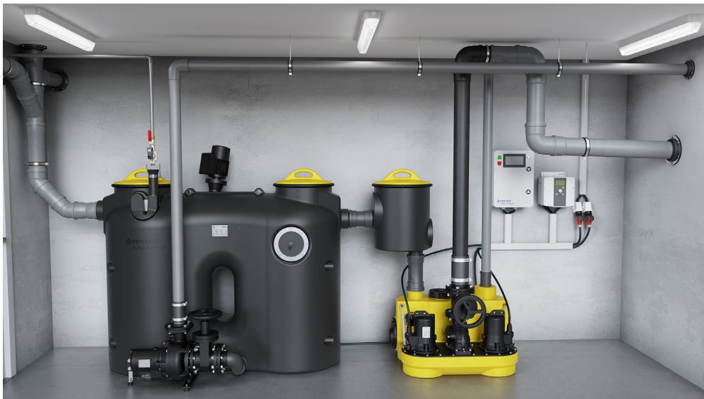
Bild 4: Splitfix Fettabscheider hier mit Probeentnahmebehälter, Entsorgungspumpe und Mixer (alles Zubehör). Bei fehlendem Rückstauschutz ist eine nachgeschaltete Hebeanlage erforderlich (hier: Compli 1000 )
