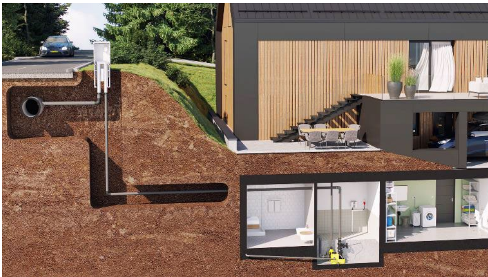
Bild 3: Im Keller ist eine Fäkalienhebeanlage installiert. Da die Rückstauenebene auf Straßenniveau liegt, müsste die vorgeschriebene Rückstauschleife durch die Kellerdecke ins Erdgeschoss geführt werden. Platzsparender ist eine außenliegende Verlegung.
